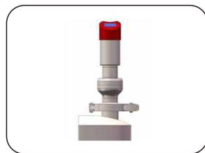
容器压力测量，电子压力开关安装在容器顶部，避免接触介质静压造成误差。
