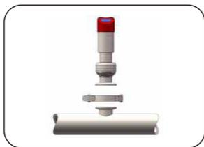
一体化电子压力开关，与过程连接直接安装。
